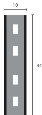
**PROF ili CTM** Сдвоенная металлическая пластина – деформационный шов со вставкой под шлифовку. Специально разработан для укладки полов на террасах; для покрытий из мрамора, гранита, известняка, которые в финале проведения работ нужно шлифовать и/или полировать. Необходимо чтобы швы тоже легко выдерживали это. Рекомендуемая ширина пролетов между швами 16мВ
